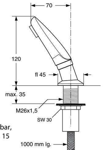
neue Handbrause maßlich abgebildet, nur noch kompl. austauschbar, mit Nippel ( M15x 1 innen / M16x1 aussen ) zum Anschluss an Pos. 15
