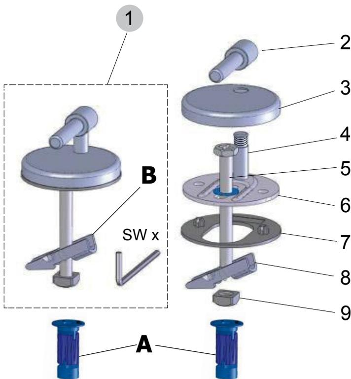
Scharnier-Set mit Befestigung **A** für Keramik mit Sackloch und mit Kippsübel-Befestigung **B** für Durchgangsloch in der Keramik.
