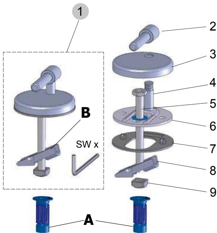
Scharnier-Set mit Befestigung **A** für Keramik mit Sackloch und mit Kippsdübel-Befestigung **B** für Durchgangsloch in der Keramik.
